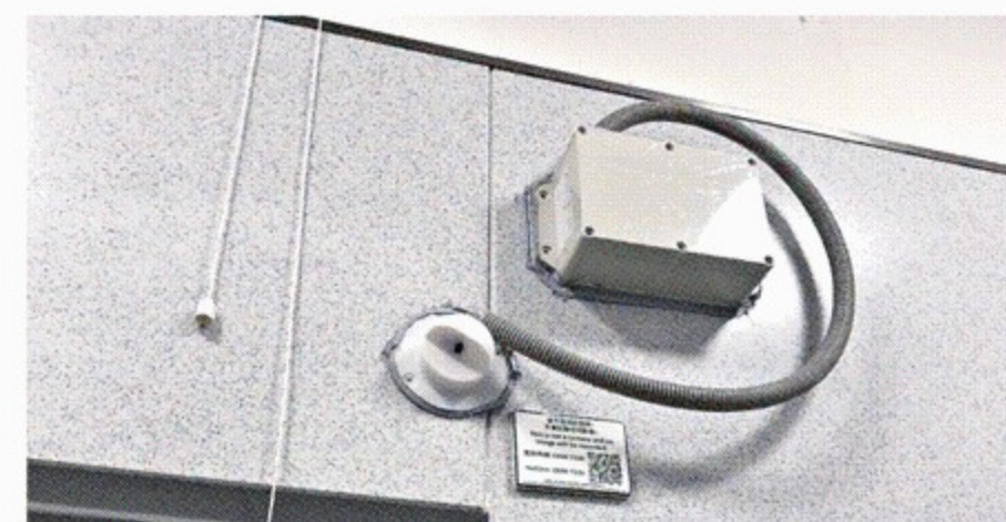
■公司在全港逾800個公廁設施提供結合人工智能（AI）、飛時測距（ToF）及物聯網（IoT）的人流點算系統服務。
