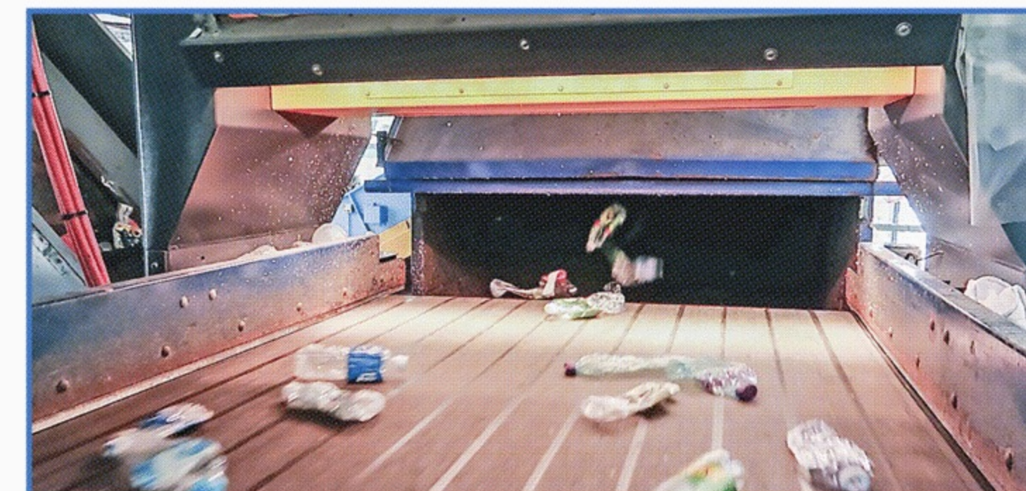
■公司在塑膠廢物分類應用近紅外線分揀技術（NIR），增加分揀精準度。
